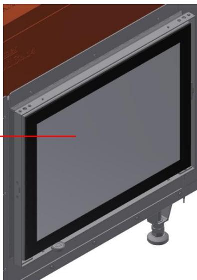
Die Anlage sollte regelmäßig, jedoch mindestens einmal pro Jahr, gereinigt werden. Entfernen Sie rechtzeitig, je nach Intensität der Benutzung die Asche. Dieses ist unbedingt durchzuführen wenn die Aschenhöhe die halbe Höhe zwischen Feuerraumtürunterkante und Feuerraumboden erreicht hat.
